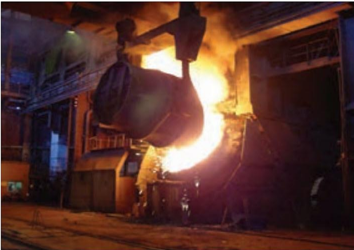
شکل ۶-۵- افزودن عناصر آلیاژی به مذاب فولاد در کارخانه فولادسازی
