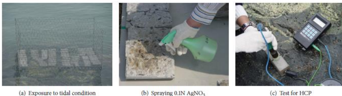
شکل ۳ تصاویر آزمایش طولانی مدت نشان دادن کلر
