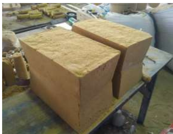
شکل ۳-۲: اتصال دو نیمه قالب به یکدیگر و ذوب ریزی.
