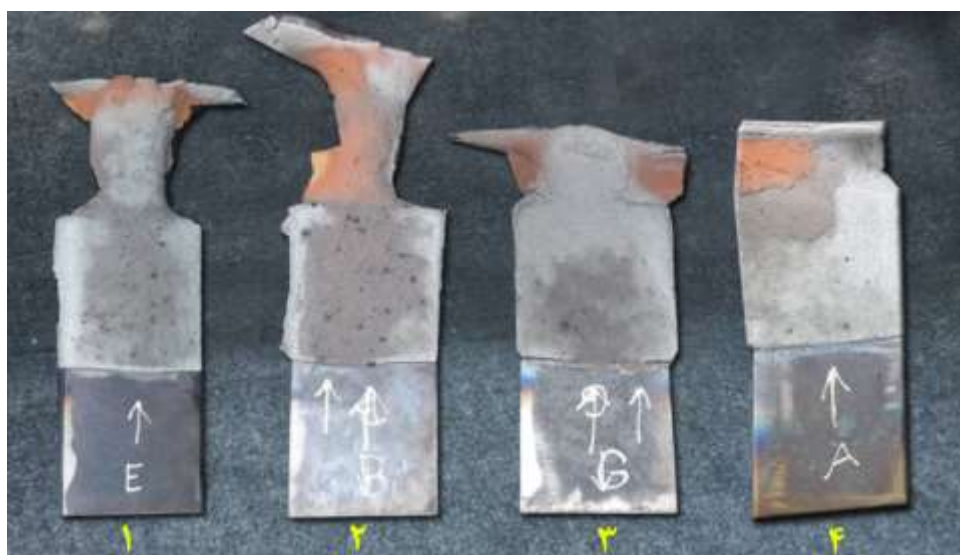
شکل ۳-۴: تصویر نمونه‌های نهایی بعد ریخته‌گری.
