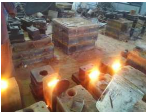
شکل ۳-۳: فرایند پیشگرمی و نمایش قالب‌ها بلافاصله بعد از ذوب ریزی.
