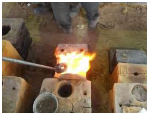
شکل ۳-۳: فرایند پیشگرمی و نمایش قالب‌ها بلافاصله بعد از ذوب ریزی.
