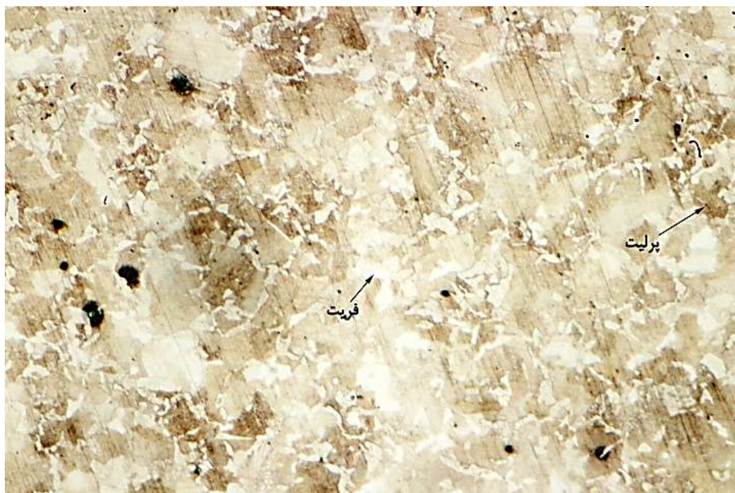
شکل ۴-۶: تصویر میکروسکوپ نوری از ریزساختار فولاد ساده کربنی AISI ۱۰۳۵.
