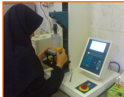
آنالیز بافت برگر به کمک دستگاه
