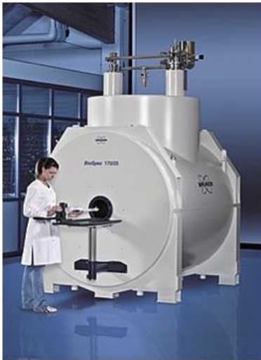
شکل ۱-۵-۱. دستگاه تصویربرداری از حیوانات کوچک (۲.۱۷ تسلا)
