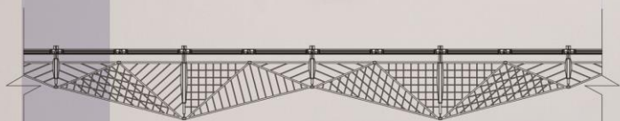
بزرگنمایی پلان (دیوار دو پوسته) مقیاس: ۱/۵۰
