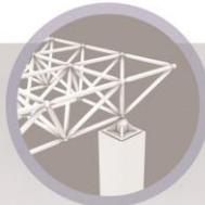
نمونه اتصال ستون به سازه سقف شیبدار، نمونه اتصال ستون به سازه فضاکار
