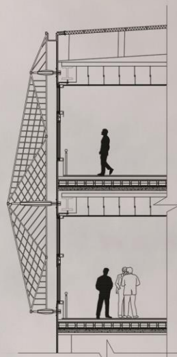
بزرگنمایی برش (دیوار دو پوسته) مقیاس: ۱/۵۰
