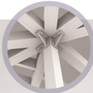
نمونه اتصال ستون به سازه سقف شیبدار، نمونه اتصال ستون به سازه فضاکار
