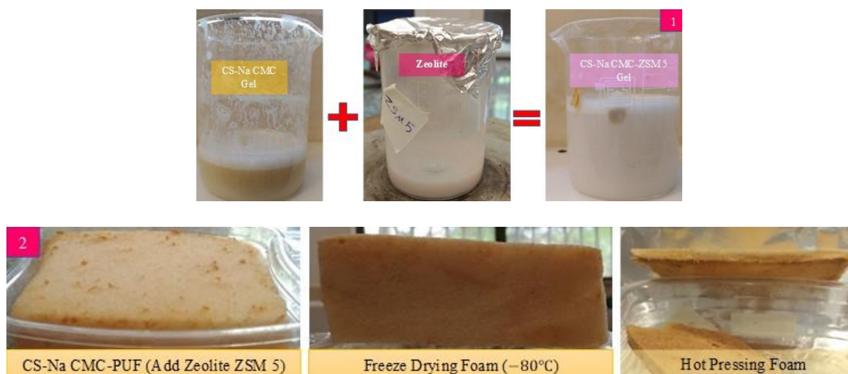
شکل (۴-۲۵): تهیه فوم (CS-Na CMC-PUF (+ Zeolite ZSM 5) - ۱) تهیه کامپوزیت ژل (۲) تهیه جاذب
