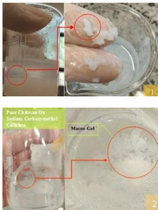
شکل (۴-۲۶): ریختن کیتوسان روی (1 CMC و 2 Na CMC)
