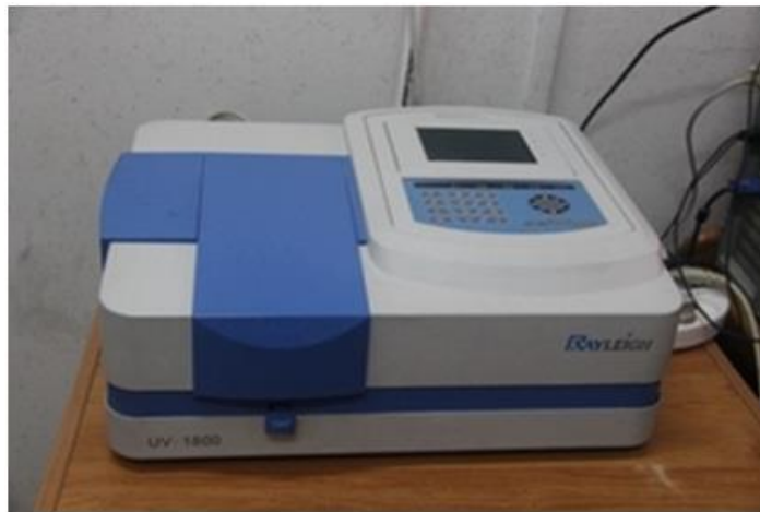
شکل ۳-۱: دستگاه اسپکتوفتومتر UV-1800 (تصویر نگارنده)
