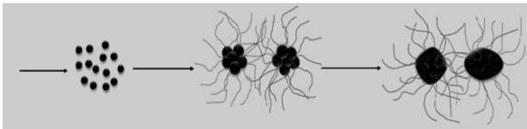
شکل ۲- روند تشکیل نانوذرات نقره به روش احیاء شیمیایی.
