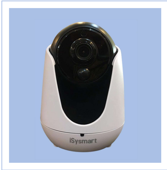
دوربین SG2607P ابعاد: 125×90×90 mm زاویه دید: افقی 95 قطر 110
