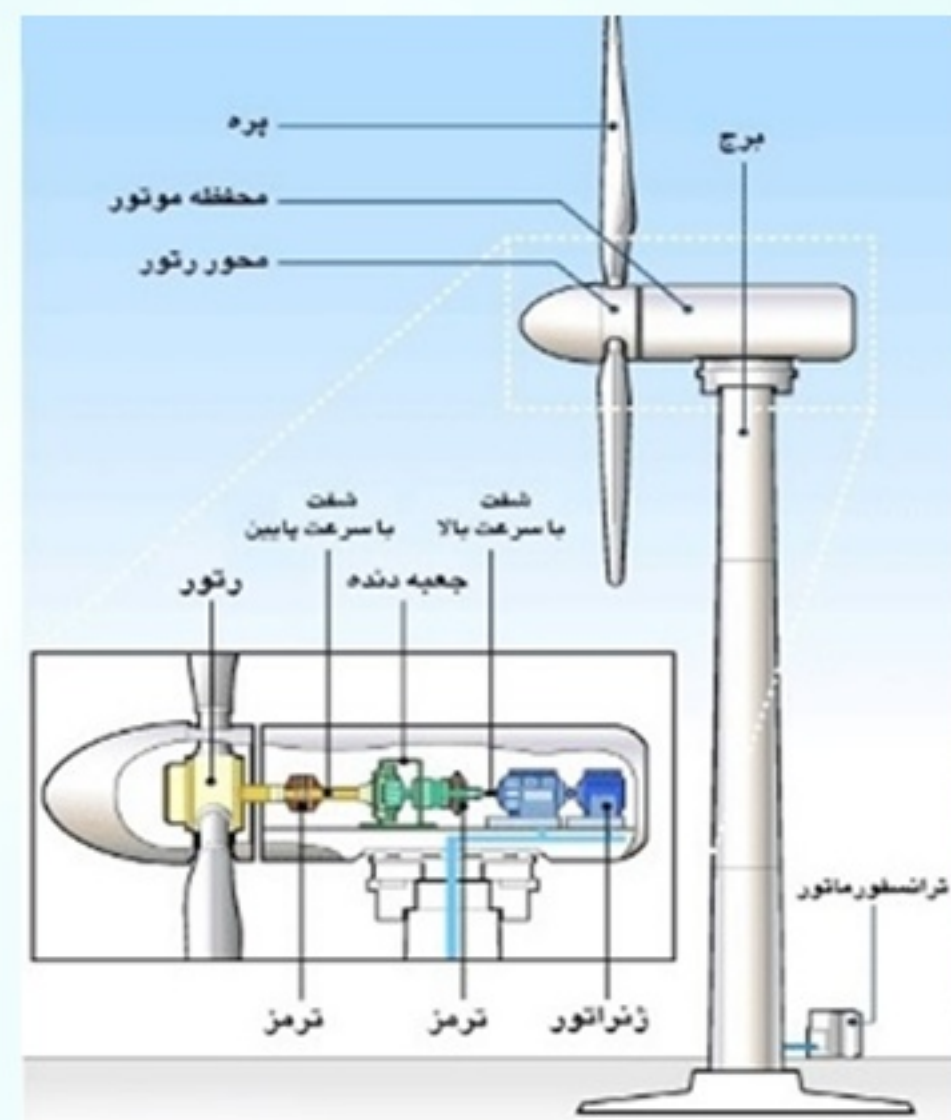
شکل ۳: ساختار یک توربین بادی
