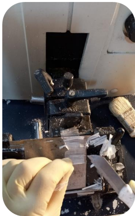
برش‌هایی به ضخامت 5 میکرومتر با دستگاه میکروتوم ایجاد شد
