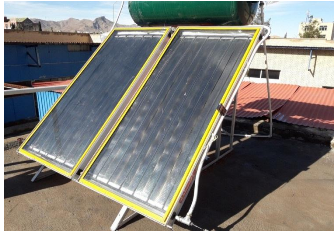
شکل ۲- تصویر بستر آزمایش آبگرمکن خورشیدی
