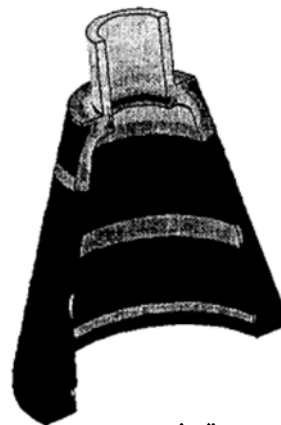
توزیع تنش وون میزز برای فلز داخلی تحت بار پیچ + بار محوری
