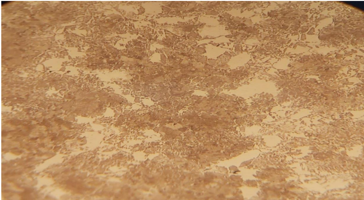
شکل 37: ریز ساختار نمونه سر پیچ ریل بزرگنمایی 200x.
