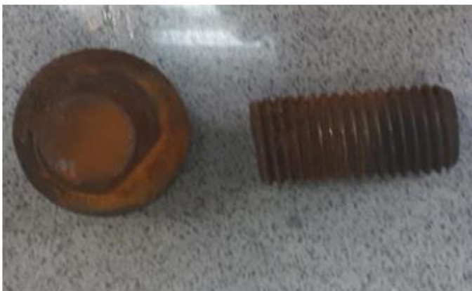
تصاویر 22 تا 24. قطعات خورده شده ریل مترو مشهد.
