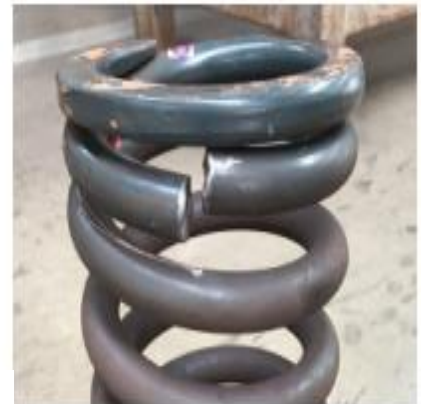
شکل 12. الف. فنر محور و چرخ، ب. تصویر اول شکست فنر کویل، ج. تصویر دوم شکست فنر کویل.
