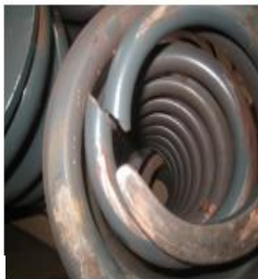
شکل 12. الف. فنر محور و چرخ، ب. تصویر اول شکست فنر کویل، ج. تصویر دوم شکست فنر کویل.
