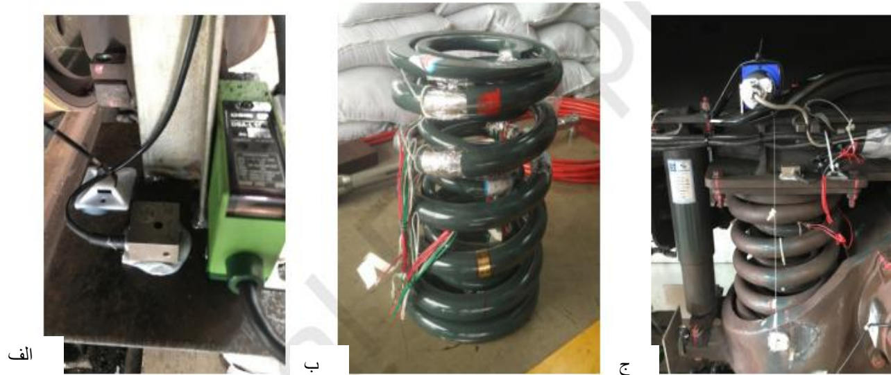
شکل 13. الف. آزمایش شتاب و جابجایی، ب. آزمایش کشش فنر، ج. مشاهده فنر کوپل تست شده.
