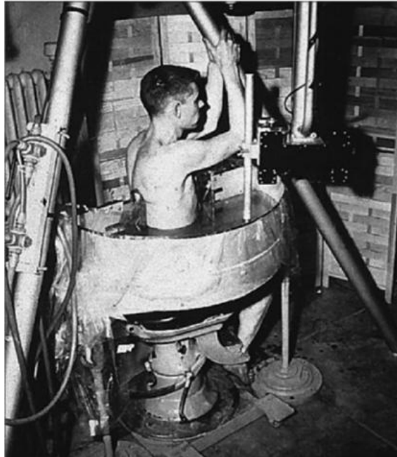
شکل ۲-۵ Pan-scanner اصلی هولمز و همکاران که برای ایجاد تصویر فراصوتی از ساختارهای بافت نرم بدن انسان طراحی شده است.
