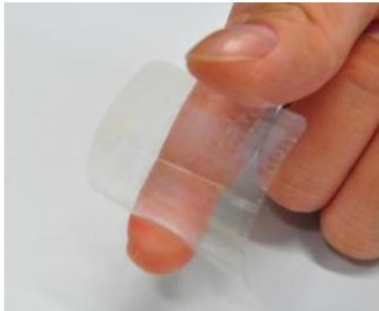
شکل ۲-۶ CMUT شفاف و انعطاف‌پذیر ساخته‌شده با روش رول لمینیت
