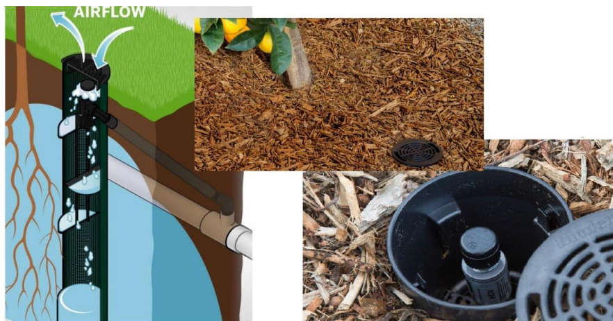
شکل ۱- تصویر سیستم آبرسانی RZWS
