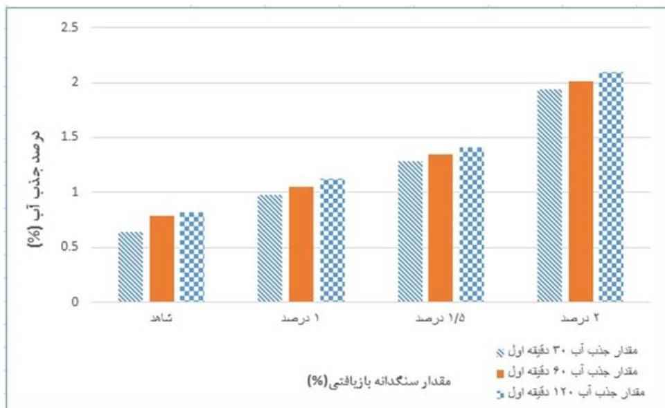
شکل شماره (۳): نمودار آزمون جذب آب در نمونه‌های دارای سنگدانه بازیافتی
