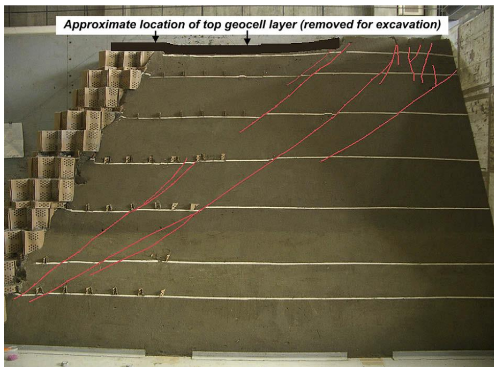
شکل ۲-۲۳: سطوح گسیختگی به وجود آمده در آزمایش پنجم لشیچینسکی و همکاران در سال
