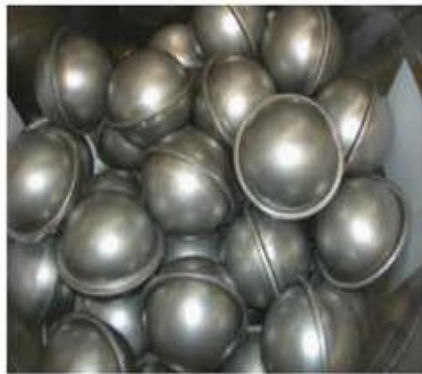
شکل ۳-۳ نمونه ای از کپسول ها، با پوسته های پلاستیکی و فلزی [7]
