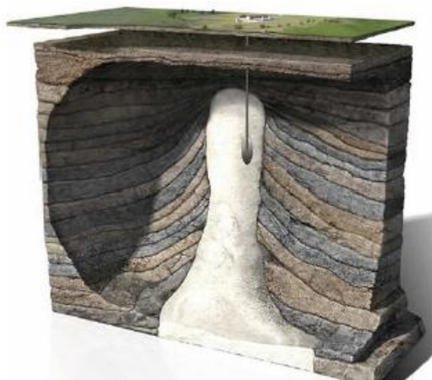
شکل ۴-۱۱ نحوه ایجاد مخزن درگنبد نمکی
