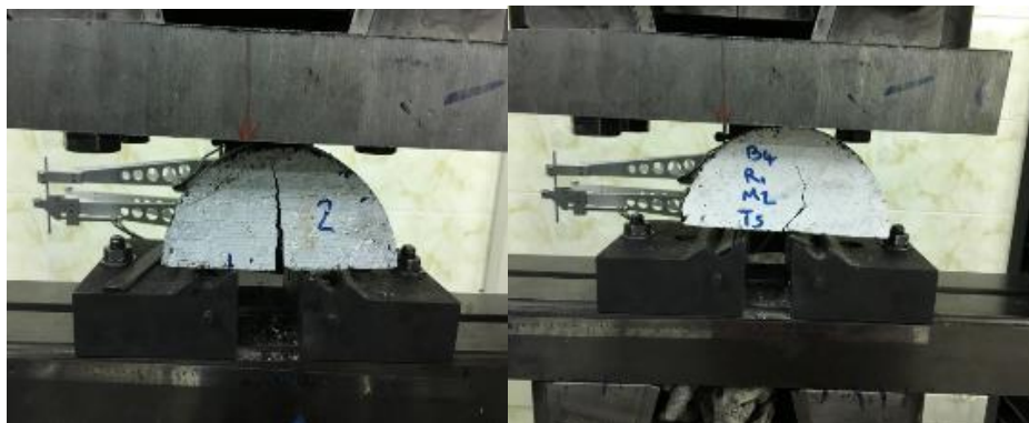
شکل ۳. نمونه‌های SCB تحت آزمایش خمش نیم‌دایره
