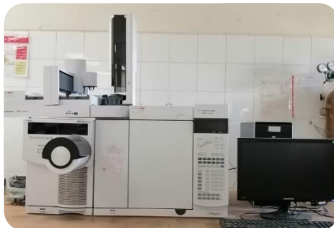
شکل ۲-۷ دستگاه GC-MS مورد استفاده جهت شناسایی ترکیبات تشکیل‌دهنده عصاره‌ها
